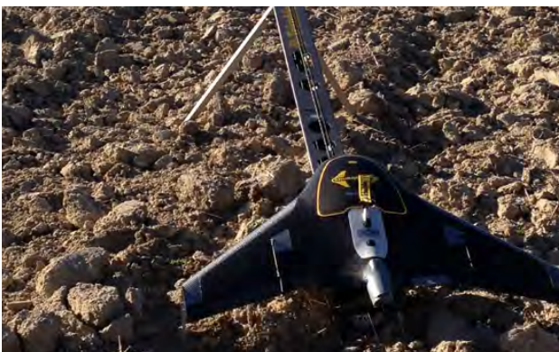
Lanzadera del dron UX-5 de Trimble, proporcionado por la casa Geotronics para la toma de datos.
